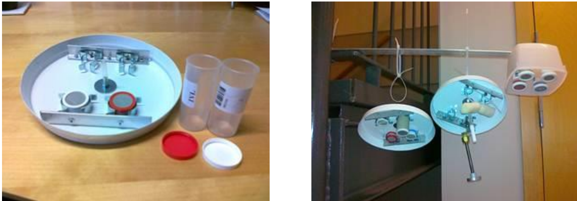
Figur 1. IVLs passiva provtagare ozon, kväveoxider, svaveldiodid, formaldehyd, flyktiga organiska ämnen och PAH (detaljer om diffusiv/passiv provtagning kan hittas i Ferm and Rodhe, 1997; Ferm, 2001).
