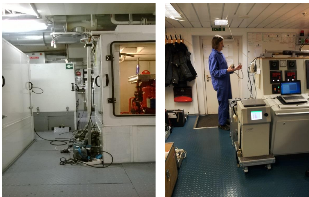
Figur 15. Bilder från mätningar: pumpad provtagning av partiklar i ett maskinrum (vänster). Mätningar av nanopartiklar med Engine Exhaust Particle Sizer (EEPS) instrumentet i maskinkontrollrummet (höger).
